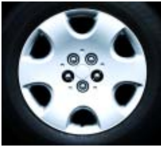
Classic 6 x 15 Zoll, Stahlfelge, abnehmbare 6-Speichen-Radzierblende, Bereifung 195/65 R15
