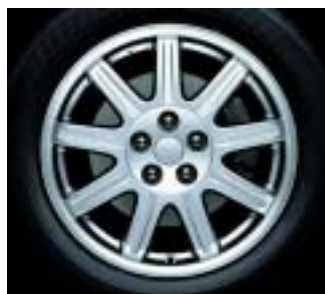
Touring 6 x 16 Zoll, Leichtmetallfelge, 9-Speichen-Design, für Bereifung 205/55 R16
