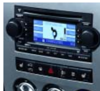
DVD-Navigationssystem Pfeilanzeige, MP3-fähig, Art.-Nr. 82209547, DVD-Kartenmaterial Westeuropa, Art.-Nr. 05064109AB
