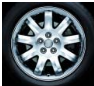
Limited 6 x 16 Zoll, Leichtmetallfelge, 9-Speichen- Radzierblende in Chrom-Design, nicht abnehmbar, für Bereifung 205/55 R16
