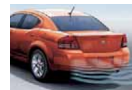
PARKPILOTSYSTEM Für hinten, 4 Sensoren in Heckstoß- stange, Akustikwarnung Artikel-Nr. 82210934
